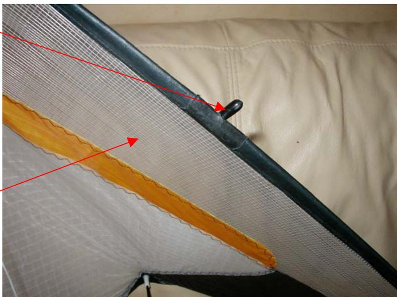
A savoir que si vous avez des blocs yoyos sur votre CV, au niveau des connecteurs de top-cross, il y a des gliss-line qui permettent d'éviter que les lignes ne se coincent au niveau de ses connecteurs lors de la mise en yoyo. Ca peut-être la gaine du bord d'attaque qui n'est pas ouverte (cas de l'I-Trix) ou une espèce de pièce en plastique souple qui se glisse autour de la barre de bord d'attaque et recouvre le connecteur (cas du 00).
